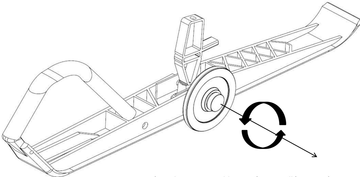
Le système de roue amovible peut être installé ou retiré en tournant la poignée de seulement 1/3 tour
